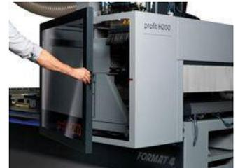
In caso di rottura di una fresa l'utente è protetto dalle lamelle laterali.
