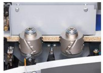
**Gruppo di incollaggio rivestito con teflon per granulato EVA 1,5 kg o PUR:**
