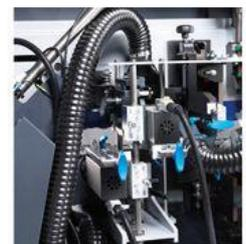
**Gruppo raschiatore con posizionamento motorizzato a 2 assi controllati incl. funzione di disinnesto pneumatico**
