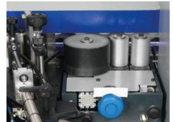
**Cesoia a ghigliottina per bordi in rotoli con uno spessore da 0,4 a 3 mm:****Gruppo intestatore con due motori ad alta frequenza:**
