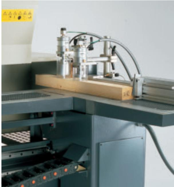
Il pezzo di legno viene posizionato sul carro a tenonare e bloccato da due pressalegni pneumatici verticali.
