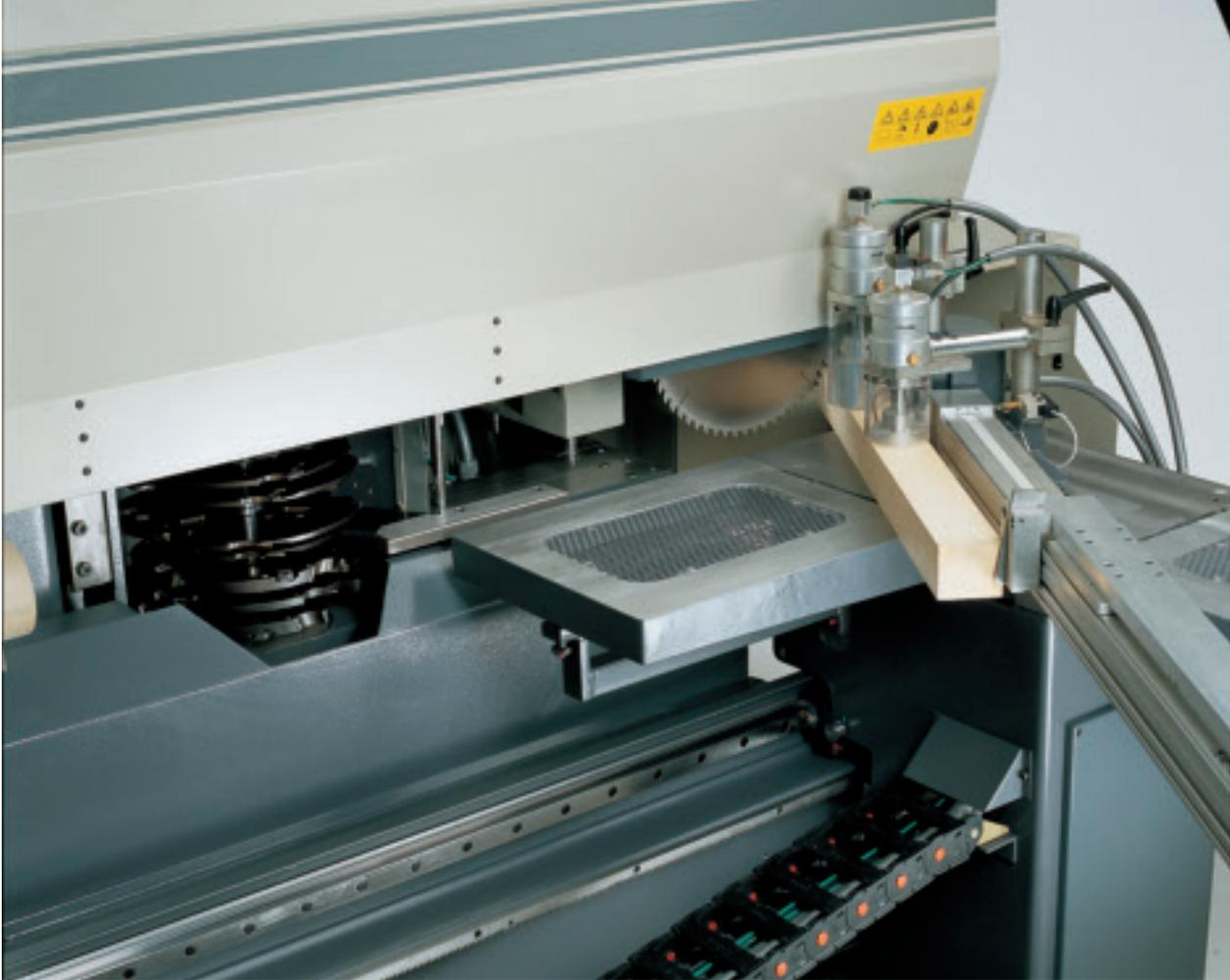
Tenoni inclinati: possibilità di eseguire tenoni inclinati tramite l'inclinazione +/- 60° della guida di appoggio, senza smontare nessun aggregato della macchina.
