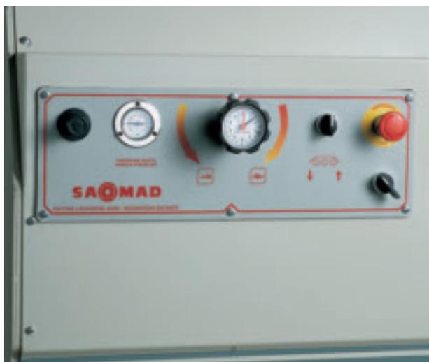
Regolazione della velocità ruote di avanzamento in continuo da 2 a 17 mt/min e regolazione della pressione pneumatica delle ruote.
