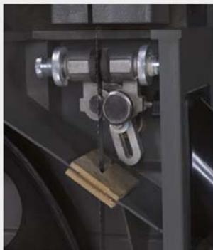
Le seghe a nastro Felder sono dotate di un guidalama superiore e inferiore con cuscinetti a rulli laterali e posteriori con regolazione di precisione, nonché di una vite di regolazione bloccabile.
