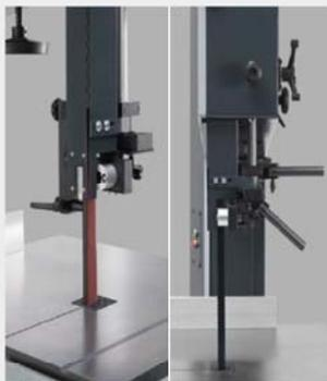
**Sempre pronto all'uso: dispositivo di levigatura a scomparsa per seghe a nastro.** Dal taglio alla levigatura in un batter d'occhio - il dispositivo di rettifica a scomparsa può restare sempre connesso alla macchina anche durante i lavori di taglio con la sega. Questo dispositivo consente di lavorare i bordi con diversi pattini di levigatura (piatti, rotondi)
