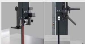
**Sempre pronto all'uso: dispositivo di levigatura a scomparsa per seghe a nastro.** Dal taglio alla levigatura in un batter d'occhio - il dispositivo di rettifica a scomparsa può restare sempre connesso alla macchina anche durante i lavori con la sega. Questo dispositivo consente di lavorare i bordi con diversi pattini di levigatura (piatti, rotondi).
