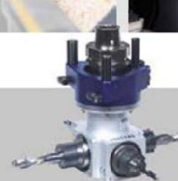
Testa angolare multipla HSK F63 con 2 uscite 2x ER 25 per utensile di foratura e fresatura e 2 uscite 2x ER 32 4 uscite ER 25
