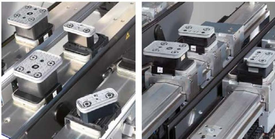
Ventose di bloccaggio con il vuoto Schmalz, sistema a mensole 2 circuiti, altezza costruttiva 100 mm
