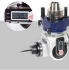
HSK F63 Gruppo orientabile, con 1 uscita ER 25 per utensile di fresatura e foratura o utensile sega, digitale, max. Ø 240 mm regolazione inclinazione e chiusura rapida
