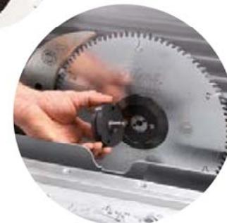
**Sostituzione senza attrezzi della lama "Easy-Lock"**
