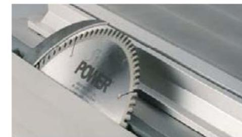
Per poter lavorare pezzi particolarmente stretti con la lama inclinata, la guida in alluminio può essere portata in posizione orizzontale.
