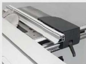
Per poter lavorare pezzi particolarmente stretti con lama inclinata, la guida in alluminio può essere portata in posizione orizzontale.
