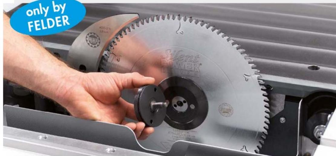
Sostituzione delle lame senza attrezzi e in assoluta sicurezza a tempo di record: il sistema di cambio rapido della lama esente da manutenzione „Easy-Lock“ offre un comfort operativo eccezionale su scala mondiale!
