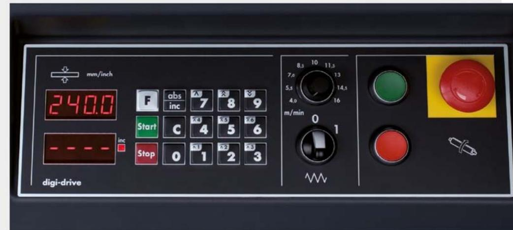
Il dispositivo di controllo programmabile „Digi-Drive“ del tavolo spessore permette l'inserimento dell'altezza del tavolo spessore in un campo numerico: il tavolo spessore si posizionerà automaticamente e con precisione. Due display a LED integrati indicano gli attuali valori reali e i valori nominali. Per ottimizzare la produttività, è possibile salvare le misure della catena e le posizioni individuali del tavolo spessore.
