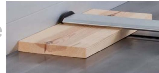
Comando del piano dello spessore con precisione al decimo di millimetro
