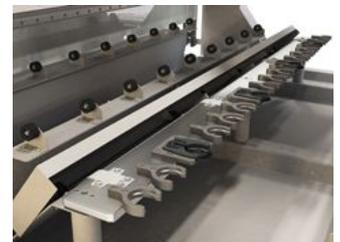
Inoltre nel cambiautensili trovano posto fino a 4 aggregati. Il posto per aggregati anteriore può essere utilizzato anche come posto "pick-up", per caricare in automatico sul mandrino utensili di fresatura o aggregati da magazzini utensili disponibili in opzione sul lato posteriore della macchina.
