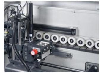
**Gruppo raschiatore con posizionamento motorizzato a 2 assi controllati incl. funzione di disinnesto pneumatico**
