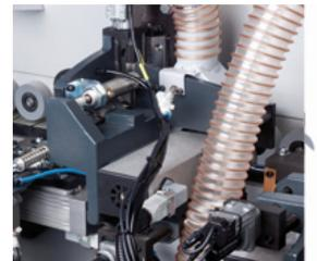
**Gruppo di lavorazione angoli per pezzi soft-forming e post-forming per la lavorazione dei bordi frontali con spessore bordo 0,4–3,0 mm e altezza pezzo 10–60 mm**
